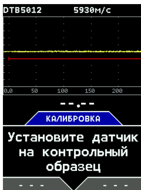
Рис.6.-8 Калибровка призмы преобразователя
