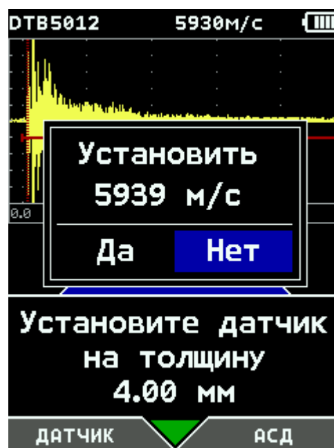
Рис.6-10 Калибровка скорости распространения УЗК
